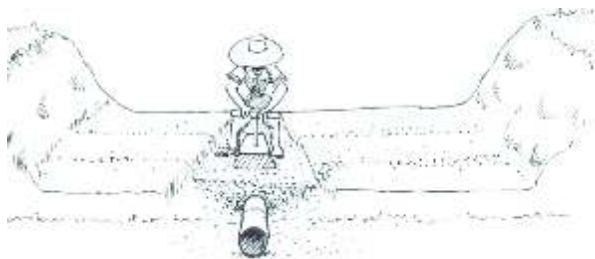
Colocación de tubería en el fondo de cauce.
