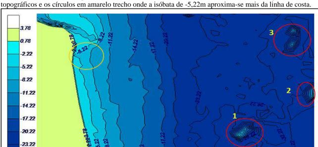
Figura 08: Batimetria da plataforma continental. Os círculos em vermelho (1, 2 e 3) representam altos topográficos e os círculos em amarelo trecho onde a isóbata de -5,22m aproxima-se mais da linha de costa.
