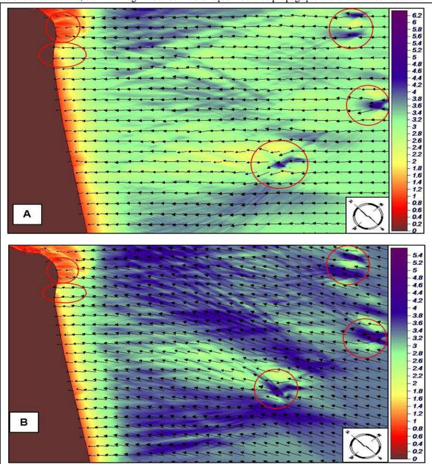
De modo geral, como era de se esperar, observa-se uma diminuição gradual da altura de ondas em direção à linha de costa. Entretanto, na Praia dos Atalaia, no trecho onde a isóbata de -5,22m se aproxima da linha de costa (ver Figura 08), é criada uma espécie de "corredor" que permite que ondas com maiores alturas alcancem a linha de costa, o que fica bem evidente nos mapas de refração das ondas de sudeste e sul-sudeste (Figura 09).
