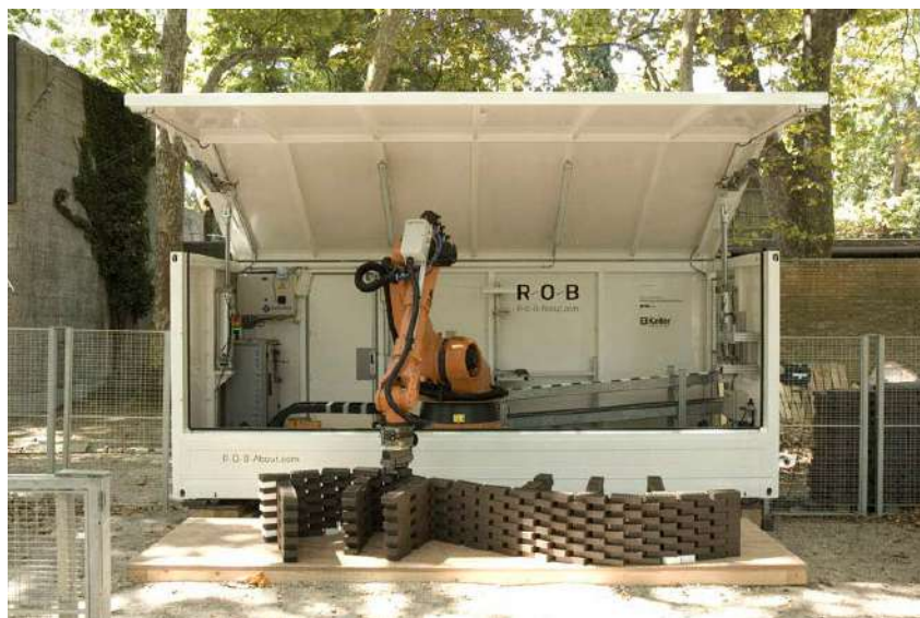
Figura 41. Imagen del dispositivo de fabricación robótica de los arquitectos Gramazio y Kohler para la Bienal de Venecia de 2008.
