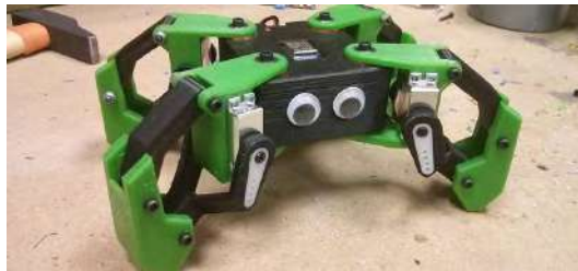
Imagen 5. Robot con esqueleto fabricado en una impresora 3D
