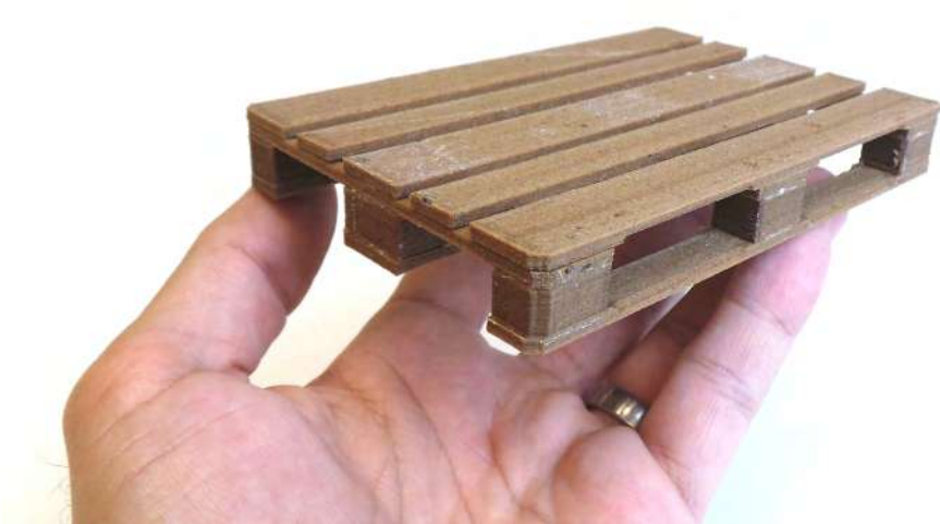
Imagen 2. Pallet en miniatura impreso con material LayWood
