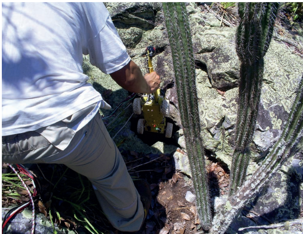
FIGURA 8A. Introducción del modelo robótica en la entrada de la pequeña cueva. Autor: Ramones.
