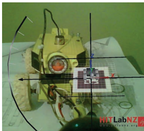
FIGURAS 5A Y 5B. Inclinómetro digital mediante tecnología de Realidad Aumentada (RA). Autor: Enrique Osman Acasio.
