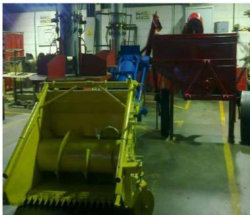
Fig. 32: Máquina recolectora de leguminosa
