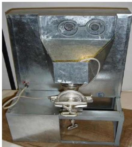
Fig.15: Prototipo Ganador Desgranadora de Maíz, Catálogo VI Salón, pag. 36, (2006)
