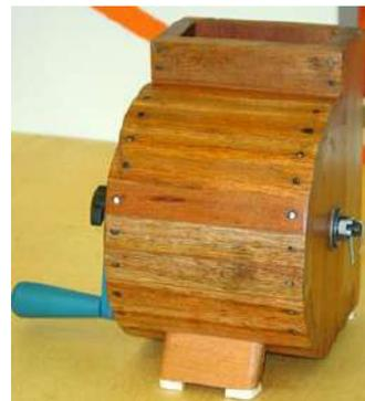
Fig.10 y 11: Esmechador de Carne /Visner Uzcáteguí (Catálogo VI
