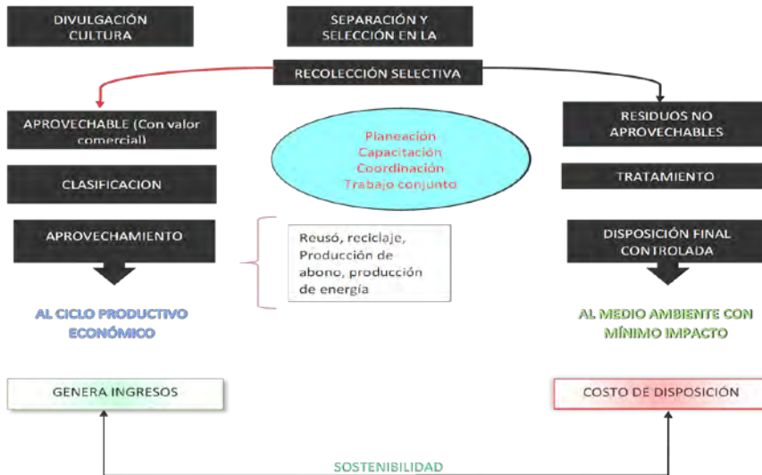
Figura 8. Esquema del tratamiento a residuos sólidos.
