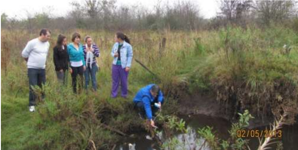
Figura 8.2: Utilizando Labdisc Gensci, directamente en curso de agua, toma de temperatura Autor: Sarita Nolla
