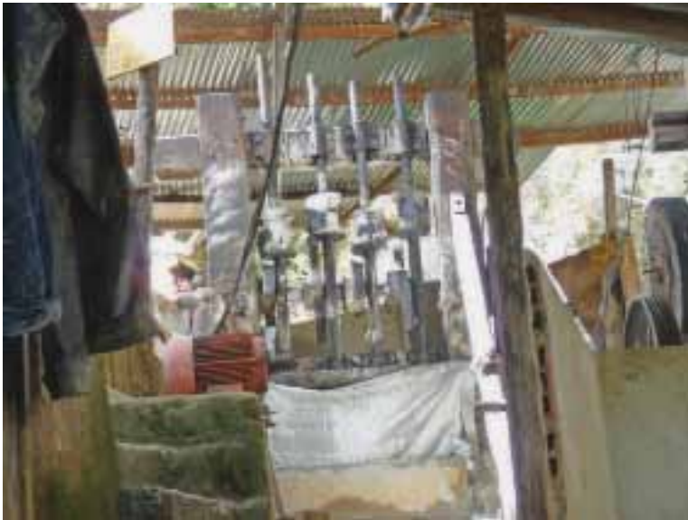
FIGURA 2. Molino californiano en la empresa La Elsy. Fotografía del autor.
