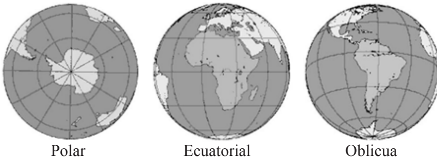
Figura 18. Tipos de proyecciones según el plano de proyección
