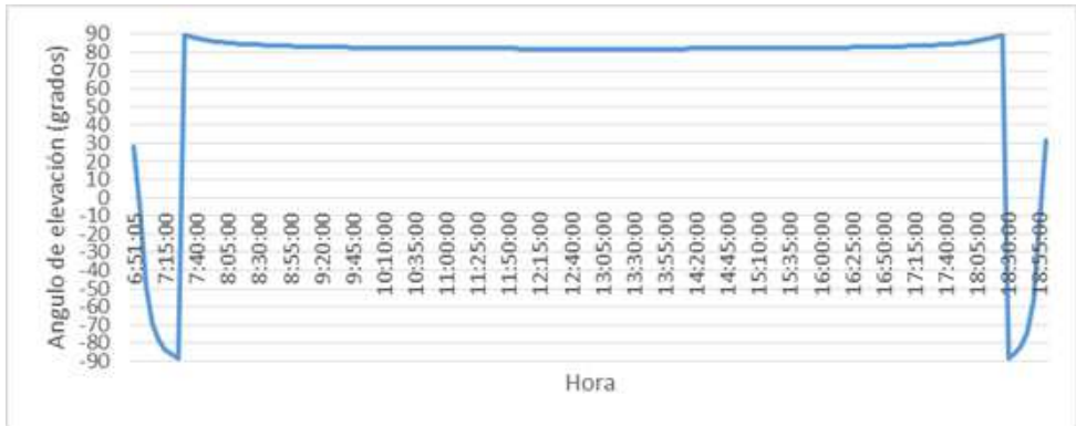
Figura 3. Elevación del sol en la proyección perpendicular al panel solar durante el tiempo solar de la ciudad de Sincelejo.
