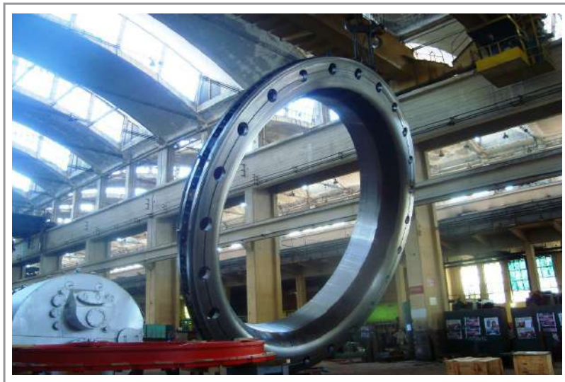
Foto 5 Taller de mecánica: movimiento de anillo para central hidroeléctrica
