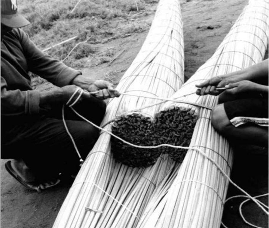
ción de la cuerda que envuelve a los bastones de la embarcación es espaciosa, disminuyendo en el extremo distal, con lo cual se logra la forma final de la embarcación (Fig. 8).
